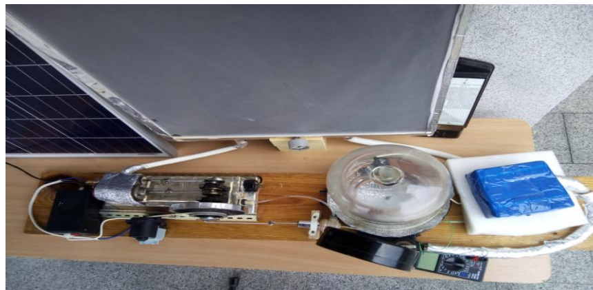
Рис.12. Вигляд зверху АП сонячної енергії з компресором Resun AIR в герметичній камері, яка з'єднана патрубком для відкачування пари.
