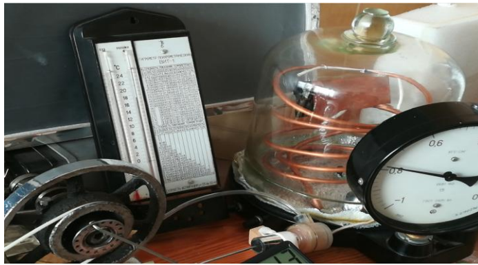
Рис.11. Температура в камері 13 С показує мультиметр, а снаружи 24 С
