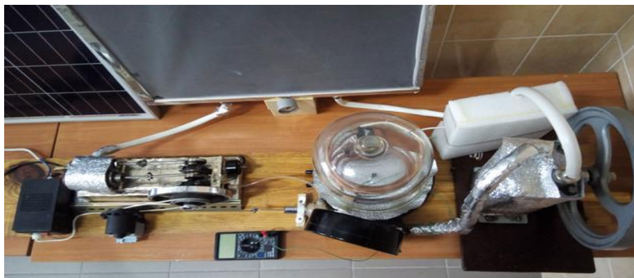
Рис.10 Вигляд зверху ЕРП сонячної енергії, де теплообмінник рекуперації справа у теплоізоляційному білому контурі у вигляді паралелепіпеда.
